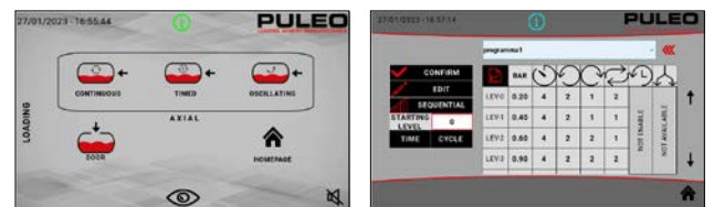
Écran PLC: sélection du type de pressurage et page pressurage en cours avec le tableau en ligne.
