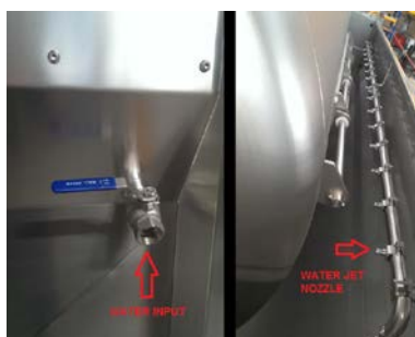
Système de lavage extérieur de la cage par buses. Sistema de lavado exterior del tambor por boquillas.
