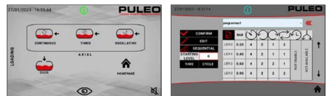
Schermo PLC: selezione tipo di pressatura e pagina pressatura in corso con grafico online di pressatura.
