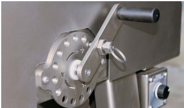
Système de réglage manuel. Sistema de ajuste manual.
