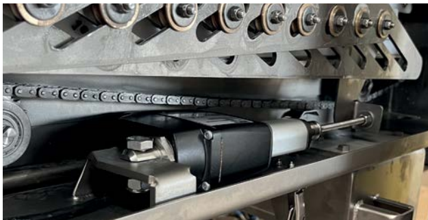
Système de réglage de la distance des rouleaux par piston électrique. Sistema de ajuste de la distancia entre los rodillos por medio de piston eléctrico (Mod. Vega25R).
