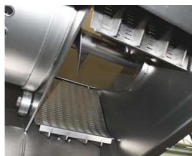
Système de égrappage partiel. Sistema de despalillado parcial.
