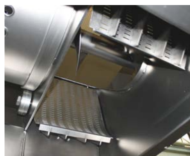
Sistema di diraspatura parziale. Partial destemming system.
