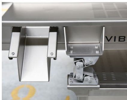
Sortie déchets et moto vibrateurs. Salida desecho y motovibradores.
