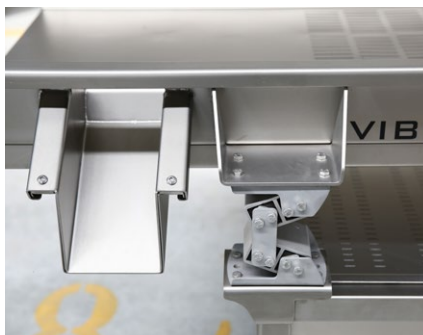
Uscita scarto e motovibratore. Waste output and motovibrator.
