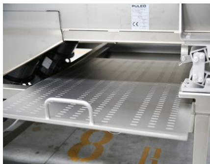
Griglia drenante di selezione, asportabile. Selection draining grid, removable.
